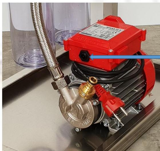
Raccorder le soufflet à air (pédale de commande ON/OFF) ici sur la photo ci-dessous le tuyau de couleur noire sur le contacteur de démarrage..
